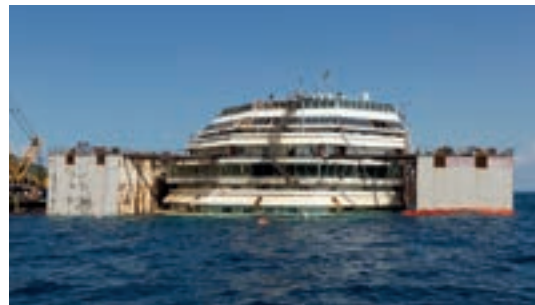
Het opdrijven is begonnen: de caissons aan weerszijden worden vol lucht gepompt en de Costa Concordia komt omhoog.
